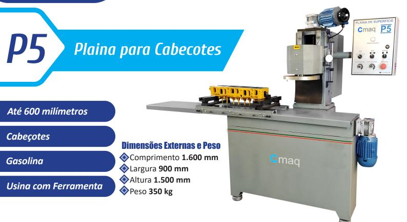
Plaina com grande robustez de estrutura e pelas fundidas (mesa, coluna, cabeçote). Ideal para usinagem de cabeçotes até 600mm de ferro fundido e alumínio. Barramento quadrado com abas inferiores que evita o efeito gangorra. Painel elétrico enclausurado que evita choques.
