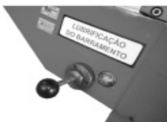
Bomba de lubrificação do Barramento
